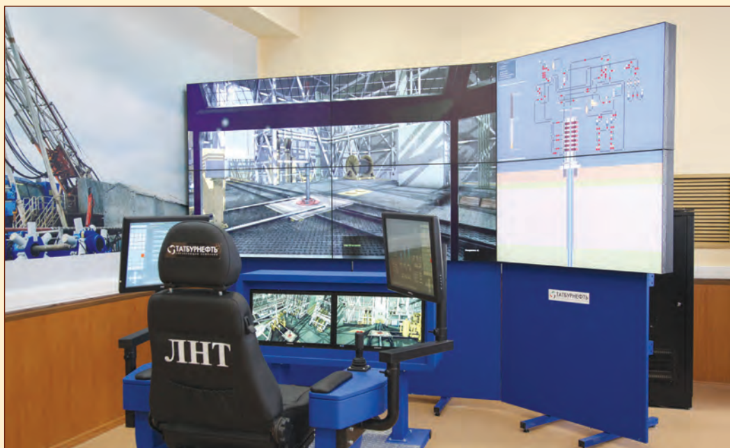
Имитатор процесса бурения «Тренажёр рабочего места бурильщика» – виртуальная реальность со знаком плюс
